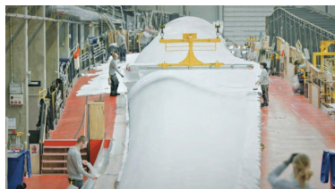
Siemens Gamesa produisant des pales d'éoliennes conçues pour être facilement recyclables. Photo : © Siemens
