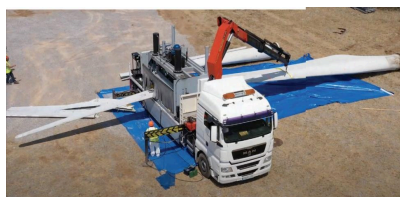
Reciclaia a mis au point Constrictor, un dispositif mobile de compression des pales. Photo : © Constrictor
