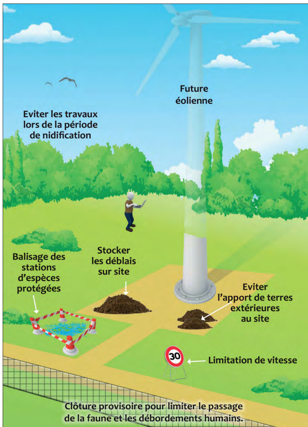
Figure 15 – Les mesures à prendre lors du chantier de construction pour éviter les dommages sur le milieu, la faune et la flore sauvages (Source : ONCFS)
