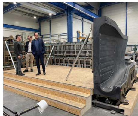
Les pales sont des pièces de très grande dimension. La partie la plus longue atteint six mètres. Ici, photo du moule. LOIRETECH
